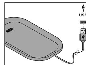
1. Schließen Sie die Ladeschale wie abgebildet an einen USB-Netzadapter (nicht im Lieferumfang enthalten) an.
